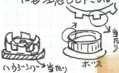
○ハウジングとインキヤ間のダンパー Springs が、大きくへたっていたら、ボス Assy の交換も考えて下さい。
