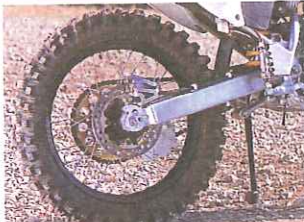
スイングアームにキャリアベースのテリを装着し、XR250Rのキャリアを装着している。まるで最初からついていたような美しい仕上がりだ
