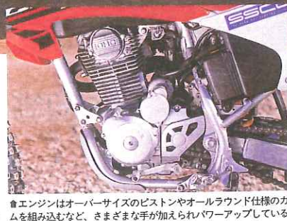
エンジンチューンに合わせて、キャブのセッティングも変更。今回はどちらかといえば、中高速でパワーの出るセッティングになっていた
